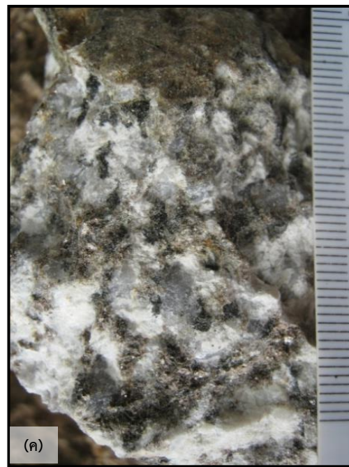
รูปที่ 11 ลักษณะเนื้อหินแกรนิตที่พบในพื้นที่ (ก) หินทิวร์มาลีน-มัสโคไวต์-ไบโอไทต์แกรนิต เนื้อขนาดเดียว (ข) หินไบโอไทต์แกรนิต เนื้อดอก (ค) หินมัสโคไวต์-ไบโอไทต์แกรนิต เนื้อขนาดเดียว
