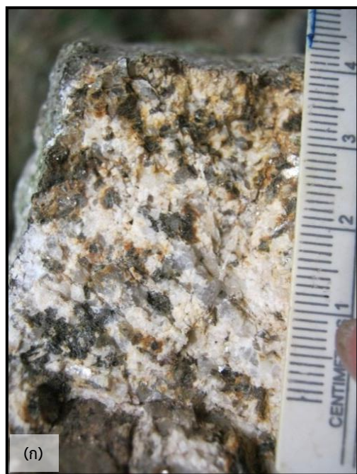
รูปที่ 11 ลักษณะเนื้อหินแกรนิตที่พบในพื้นที่ (ก) หินทิวร์มาลีน-มัสโคไวต์-ไบโอไทต์แกรนิต เนื้อขนาดเดียว (ข) หินไบโอไทต์แกรนิต เนื้อดอก (ค) หินมัสโคไวต์-ไบโอไทต์แกรนิต เนื้อขนาดเดียว
