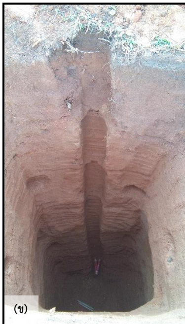
รูปที่ 18 (ก) ลักษณะเนื้อดิน/หินผุ ของชั้นหน้าตัดดิน ในพื้นที่แหล่ง “นางแล” (ข) ลักษณะชั้นเนื้อดิน/หินผุ ภายในหลุมทดลอง (ค) ลักษณะเนื้อหินไบโอไทต์แกรนิตเนื้อดอก ผลึกขนาดปานกลาง
