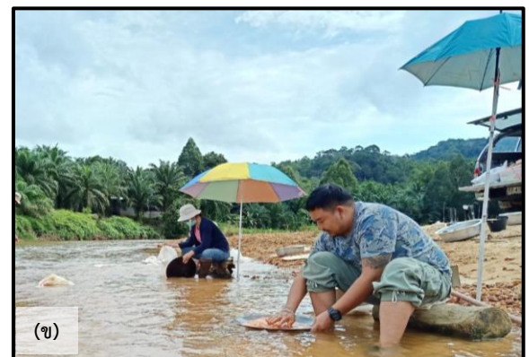
รูปที่ 6 (ก) การเก็บตัวอย่างในชั้นกะสะทางน้ำ และ (ข) การเลียงตัวอย่างเพื่อตรวจดูปริมาณแร่หนักที่ตกค้างในชั้นดิน/หินผุ และในชั้นกะสะทางน้ำ
