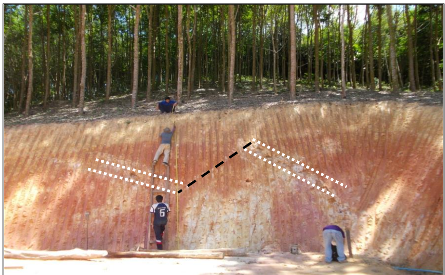
รูปที่ 13 ลักษณะหน้าตัดดินที่มาสายควอตซ์ฝู (เส้นไข่วางสีขาว) และ รอยเลื่อนตัดผ่าน (เส้นประสีดำ) เข้ามาในเนื้อหินมีสโคไวต์-ไบโอไทต์ฝู ในพื้นที่แหล่ง “เขาทรายแดง”
