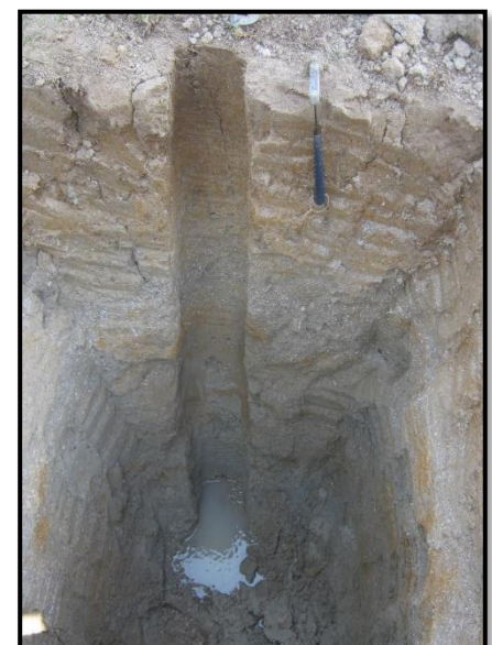
รูปที่ 7 การขุดหลุมทดลองเพื่อศึกษา ลักษณะเนื้อดิน/หินผุและระดับการผุสลายทางเคมีของเนื้อหิน
