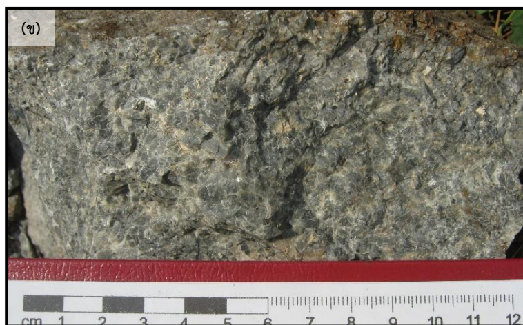
รูปที่ 22 (ก) ลักษณะเนื้อดิน/หินผุ ของชั้นหน้าตัดดิน ในพื้นที่แหล่ง “แพมบก” (ข) ลักษณะเนื้อหินไซอีไนต์ ผลึกขนาดปานกลาง (ค) ลักษณะเนื้อหินไซอีไนต์ ผลึกขนาดละเอียด
