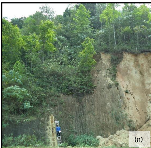
รูปที่ 26 (ก) ลักษณะเนื้อดิน/หินผุของชั้นหน้าตัดดิน ในพื้นที่แหล่ง “ละออบ” (ข) ลักษณะเนื้อหินโปไอโทต์แกรนิตเนื้อดอก ในพื้นที่แหล่ง “ละออบ”
