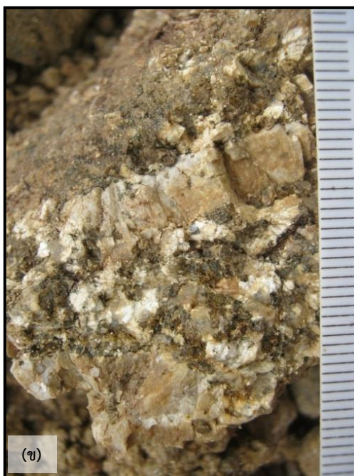
รูปที่ 11 ลักษณะเนื้อหินแกรนิตที่พบในพื้นที่ (ก) หินทิวร์มาลีน-มัสโคไวต์-ไบโอไทต์แกรนิต เนื้อขนาดเดียว (ข) หินไบโอไทต์แกรนิต เนื้อดอก (ค) หินมัสโคไวต์-ไบโอไทต์แกรนิต เนื้อขนาดเดียว
