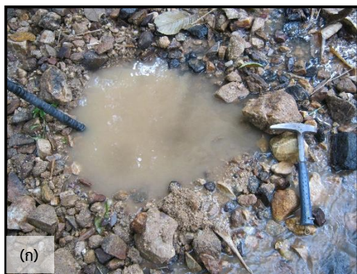
รูปที่ 6 (ก) การเก็บตัวอย่างในชั้นกะสะทางน้ำ และ (ข) การเลียงตัวอย่างเพื่อตรวจดูปริมาณแร่หนักที่ตกค้างในชั้นดิน/หินผุ และในชั้นกะสะทางน้ำ
